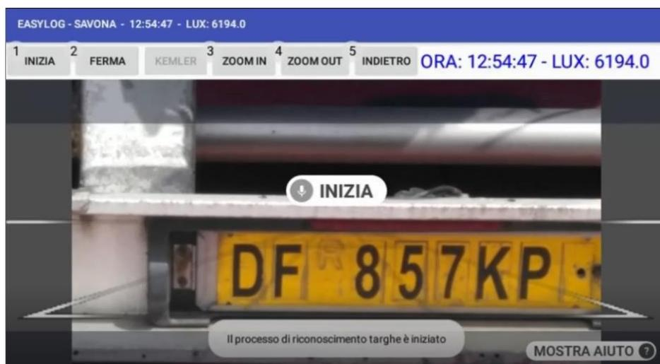
Le funzioni "INIZIA" e "FERMA" servono a far partire e fermare il processo di riconoscimento delle targhe. Quando la targa viene riconosciuta con una tolleranza superiore all'80%, viene mostrata in un popup e l'operatore può scegliere se confermare il riconoscimento oppure scartarlo:
