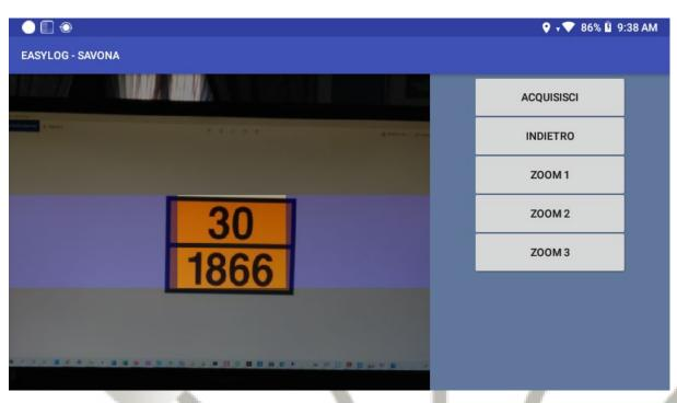
L'operatore ha a disposizione tre livelli di zoom per facilitare l'inquadratura della targa ADR all'interno del rettangolo mostrato sul visore.
