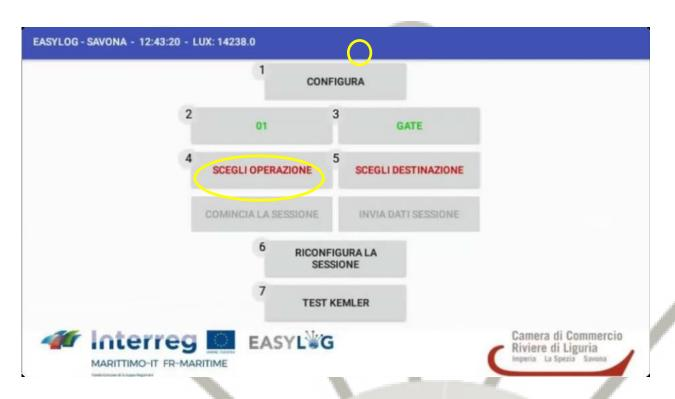
Ad esempio per impostare il tipo di operazione l'operatore pronuncia «scegli operazione» oppure «seleziona elemento **4**»
