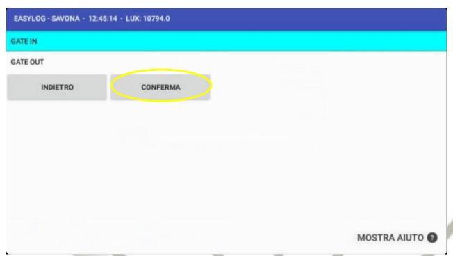
Pronunciando il nome del tipo di operazione, ad esempio «GATE IN», e poi «conferma», l'operatore imposta il tipo di operazione.
