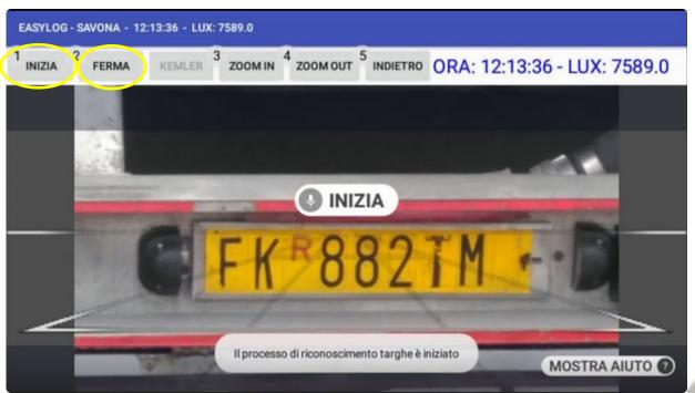
Per iniziare e terminare la procedura di riconoscimento della targa del mezzo l'operatore pronuncia rispettivamente «INIZIA» e «FERMA»
