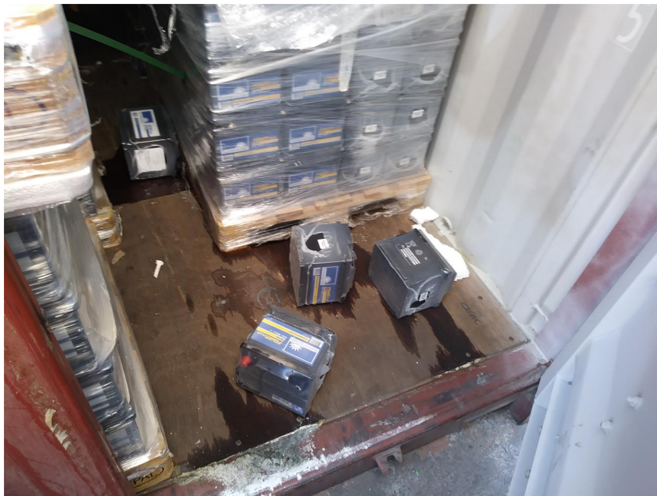
Rovesciamento di alcuni colli di batterie contenenti Acido Solforico; classe 8 UN 2794
