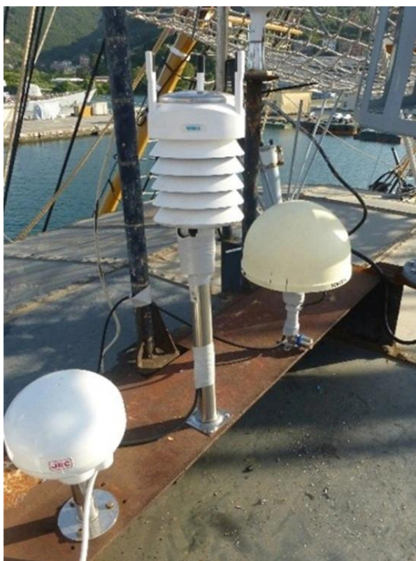
Fig. 3 Strumentazione a bordo di Nave Vespucci gentilmente messa a disposizione: Ricevitore GNSS Topcon NET-G3A e antenna G3-A1 - Topcon Positioning Italy srl Centralina meteorologica Vaisala WXT536 - Eurelettronica ICAS srl
